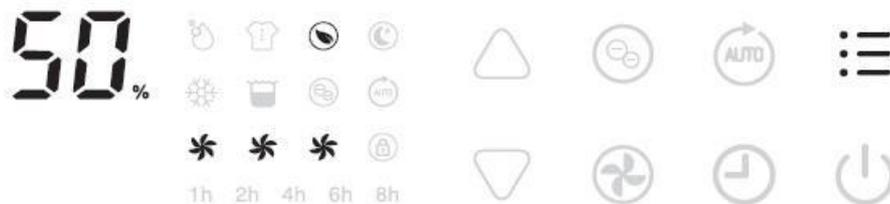
Drücken Sie diese Taste zweimal, um den Luftreinigungsmodus zu wählen. Das Gerät läuft mit hoher Lüftergeschwindigkeit ohne Entfeuchtung. Die Lüftergeschwindigkeit kann eingestellt werden.
