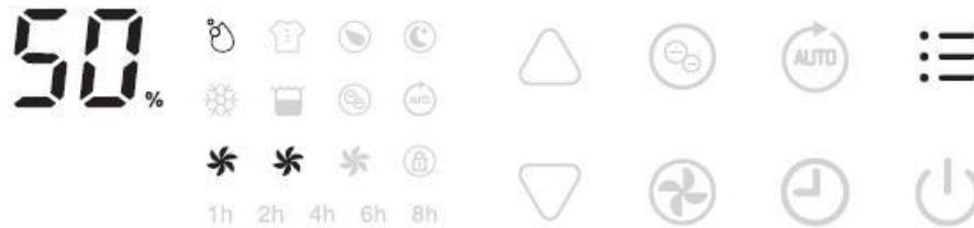
Drücken Sie diese Taste viermal, um den Manuellen Modus zu wählen. Das Gerät wird in Standardeinstellung mit kontinuierlicher Entfeuchtung bei mittlerer Lüfterdrehzahl arbeiten.
