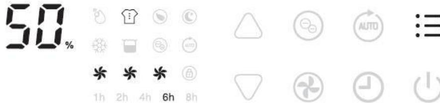
Durch einmaliges Drücken dieser Taste wird der Wäschetrocknungsmodus ausgewählt. Das Gerät läuft 6 Stunden lang im kontinuierlichen Entfeuchtungsmodus mit hoher Lüftergeschwindigkeit und schaltet sich dann automatisch ab. Lüftergeschwindigkeit und Timer können nicht eingestellt werden.
