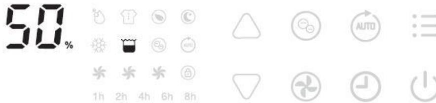
Wenn der Tank mit Wasser gefüllt ist, leuchtet die Anzeige für den vollen Tank auf, und das Gerät wechselt in den Standby-Modus. Nachdem der Behälter geleert und wieder ins Gerät eingesetzt wurde, wechselt dieses in den vorherigen Modus.
