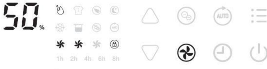
Drücken Sie die Lüftergeschwindigkeitstaste 2 Sekunden lang, um alle Tasten zu sperren. Auf gleiche Weise entsperren Sie sie.
