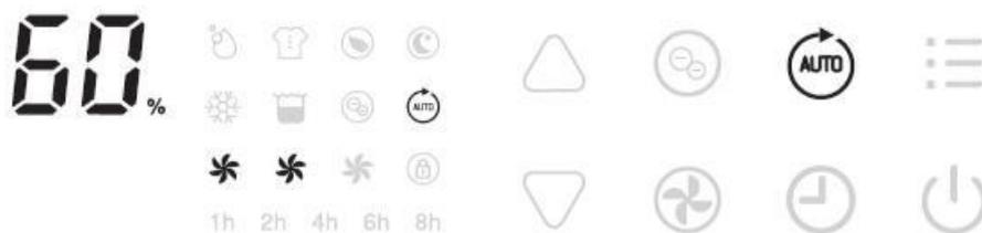
Durch Drücken dieser Taste wird der automatische Entfeuchtungsmodus ausgewählt. Das Gerät startet automatisch entsprechend der erkannten Umgebungsfeuchtigkeit (RF – relative Luftfeuchtigkeit).
