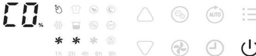
Drücken Sie den Netzschalter einmal, um das Gerät einzuschalten. Das Gerät läuft im Standardmodus, wobei die manuelle, kontinuierliche Entfeuchtung bei mittlerer Lüftergeschwindigkeit erfolgt.
